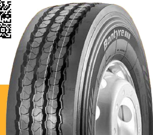
Всесезонная шина предназначена для установки на рулевую ось, но так же показывает превосходные эксплуатационные характеристики на прицепных осях.
