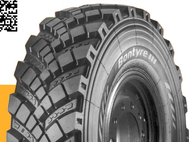
Шина с регулируемым давлением, протектором повышенной проходимости на каркасе ЦМК. Предназначена для установки на любые оси полноприводных вездеходов и прицепов.
