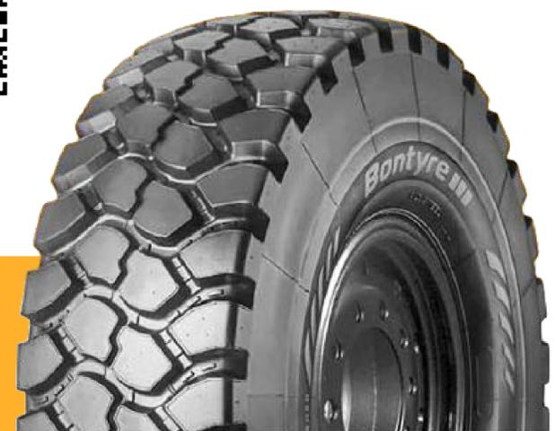
Всесезонная грузовая камерная шина с протектором повышенной проходимости на каркасе ЦМК.
