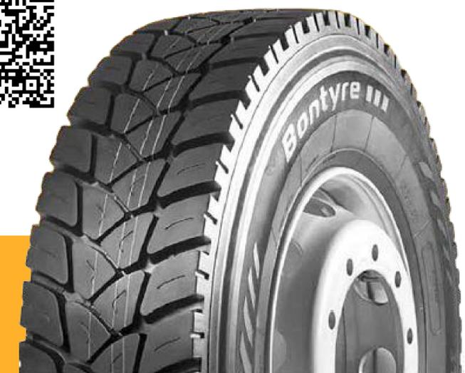
Шина разработана для установки на ведущую ось.
